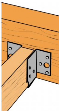
Fixation de pannes sur support bois
